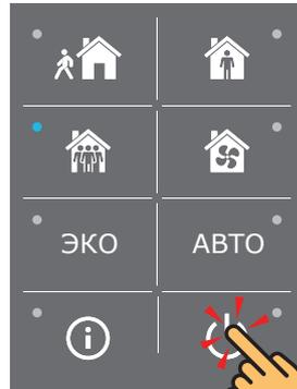
Для выключения установки нужно нажать кнопку включения / выключения.
