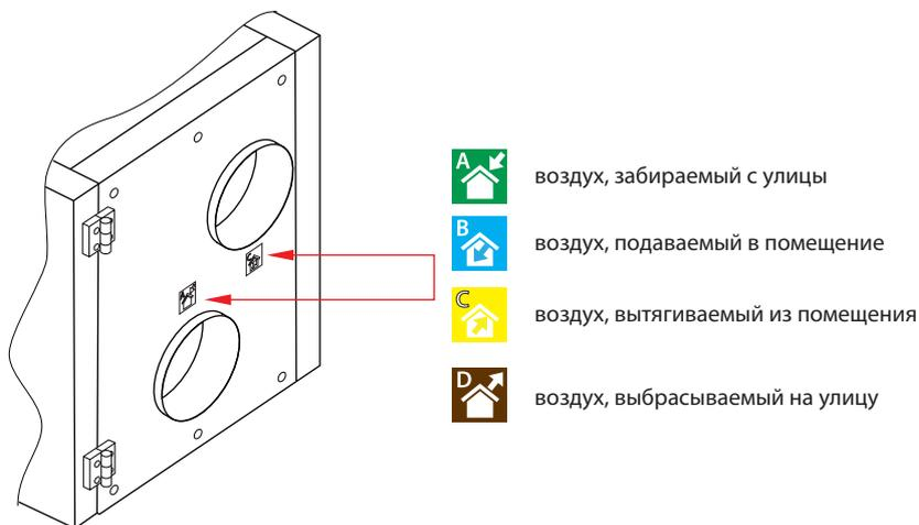
Рис. 8. Обозначение воздуховодов
