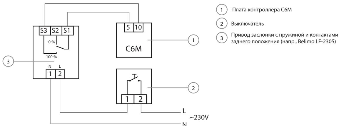
Рис. 15. Пример включения вентиляционного режима «Преимущество», когда используется дополнительная вытяжка воздуха с моторизированной заслонкой (см. рис. 9)
