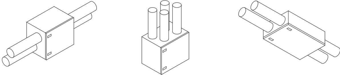
**Рис. 1.** Распределение установок по подключению воздуховодов
