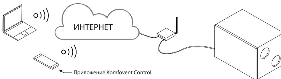
Рис. 20. Примеры подключения установки к местной сети или к интернету
