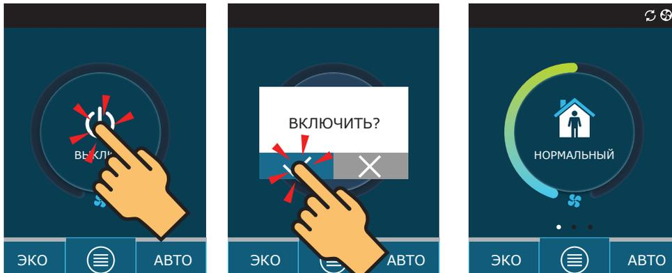
В течение первой минуты после запуска автоматика установки проанализирует настройки, проверит компоненты автоматике и откроет воздушные заслонки (если в системе воздуховодов установлены и подключены воздушные заслонки с приводом). Затем будет дан сигнал вентиляторам, и установка включится в режиме вентиляции, в котором она была выключена.
