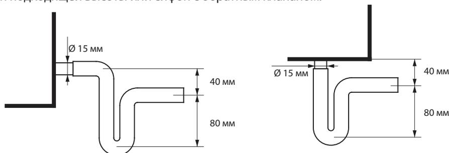
Рис. 11а. Монтаж сифона без обратного клапана
