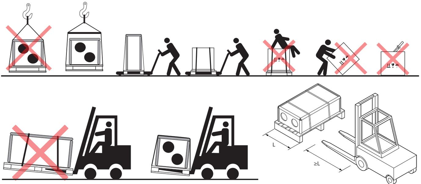
Рис. 4. Примеры транспортировки при помощи крана, автопогрузчика и технологической тележки
