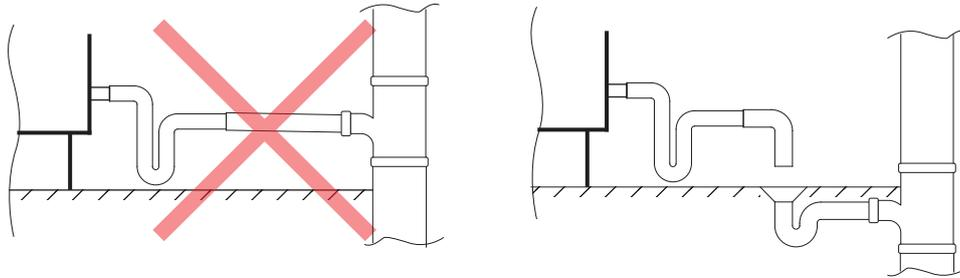
Рис. 116. Подключение отвода конденсата к канализационной системе
