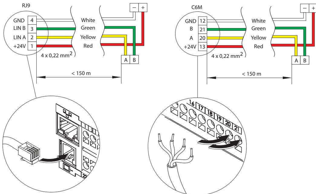
Рис. 16. Электрическая схема провода пульта
