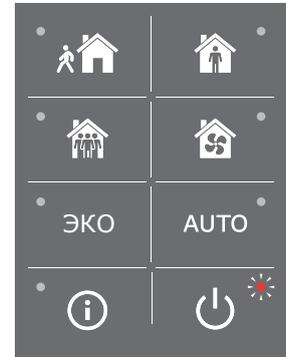
После остановки установки рядом с кнопкой включения / выключения загорится красная индикаторная лампочка.
