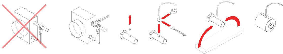
Рис. 10. Подключение патрубков водяного нагревателя/охладителя и установка датчика температуры воды
