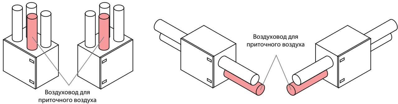
**Рис. 2.** Распределение установок по стороне осмотра
