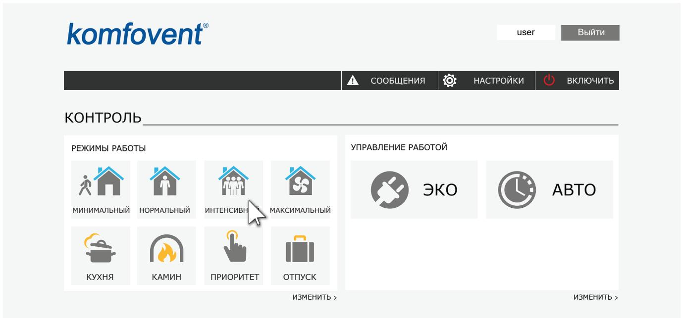
Установка останавливается нажатием на кнопку «ВЫКЛЮЧИТЬ»:
